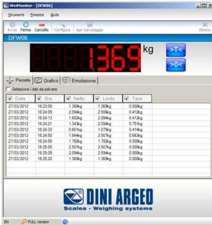
WeiMonitor ist ein PC-Programm, das die Überwachung, die Aufzeichnung und das Schreiben in der geöffneten Windows-Anwendung ermöglicht. In Echtzeit können alle abgeschlossenen Wägungen, die auf der angeschlossene Waage durchgeführt wurden, als Text- oder Excel-Datei gespeichert werden.
